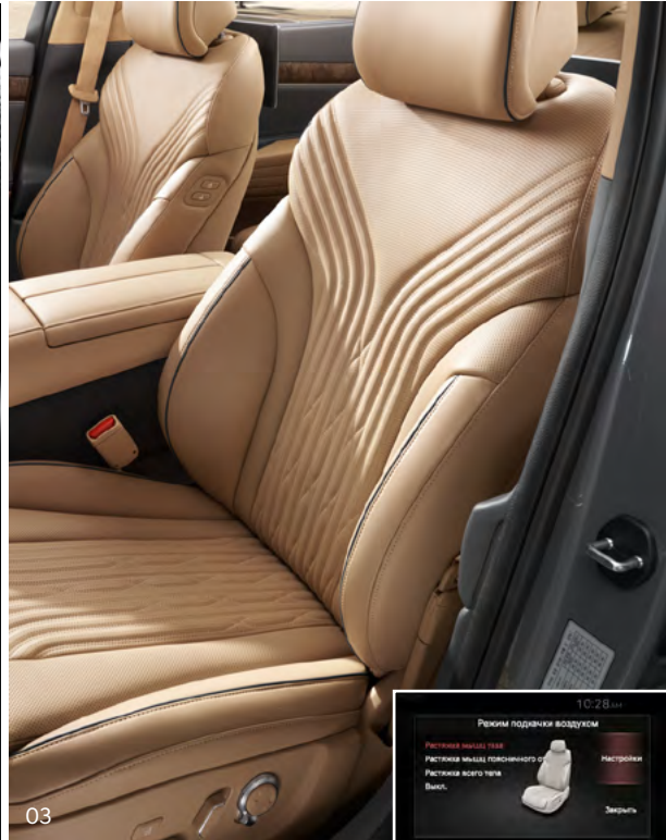
03. Водительское кресло ERGO motion _ Кресло водителя оборудовано системой ERGO motion. Подача воздуха в каждую из семи камер, встроенных в сиденья, регулируется индивидуально для создания идеального положения. Интенсивность боковой поддержки может изменяться в зависимости от режима вождения и скорости прохождения поворотов. А режим разминки помогает снизить усталость в дороге.
