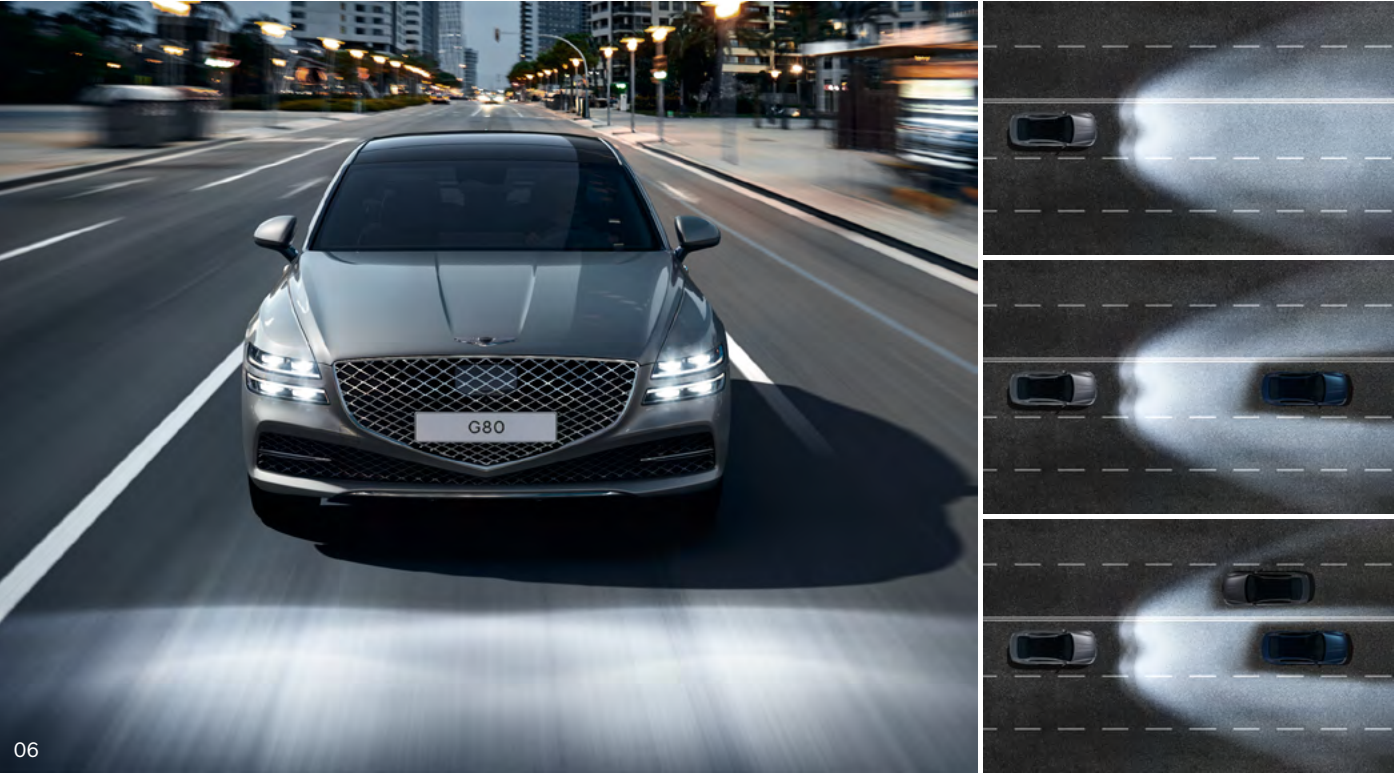
06. Интеллектуальная система управления светом (IFS) _ Автоматически включает и выключает часть ламп в фарах дальнего света, предотвращая ослепление водителей автомобилей, следующих в попутном или встречном направлениях. Функция избавляет от необходимости ручного переключения между дальним и ближним светом.
