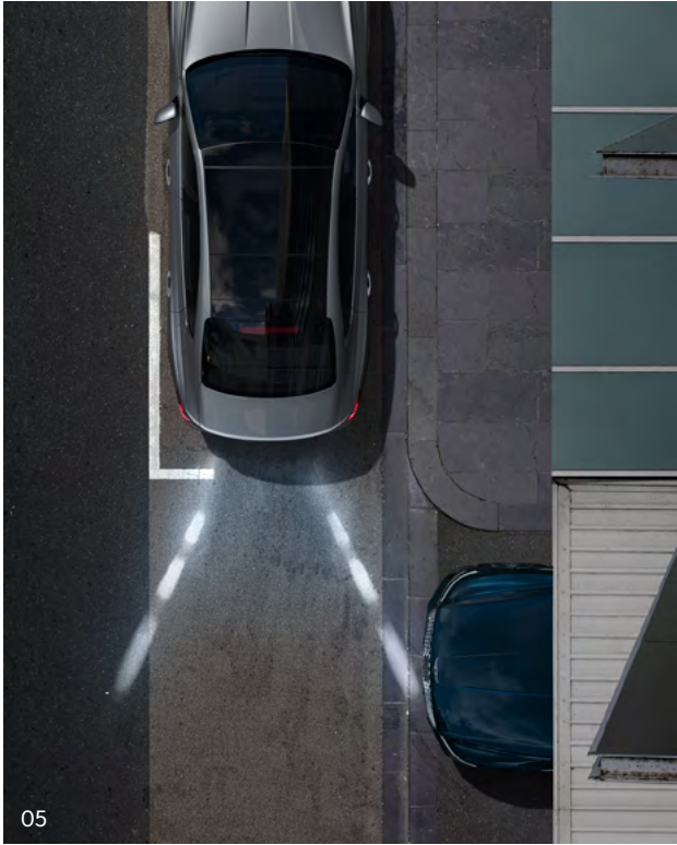
05. Предупреждающая подсветка при движении задним ходом _ Проецирует на дорогу две световые полосы, предупреждая пешеходов и другие транспортные средства о движении задним ходом.
