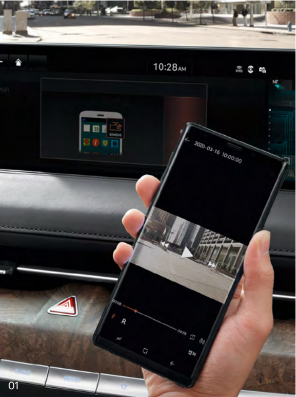
01. Встроенный видеорегистратор _ В передней и задней частях автомобиля установлены камеры высокого разрешения. Изображение с камер сохраняется во встроенной памяти мультимедийной системы. Пользователь может просматривать запись на широкоформатном дисплее или на экране смартфона, а также скачивать сохранённые видеофайлы.
