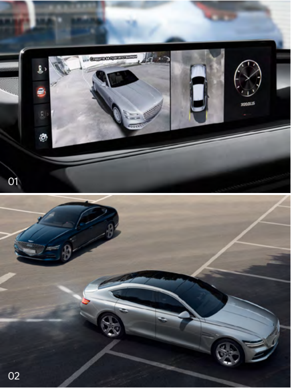
01. 02. Система кругового обзора _ Обеспечивает 360-градусный 3D-обзор обстановки вокруг автомобиля. Система предотвращения бокового столкновения (RCCA) _ При движении задним ходом предупреждает водителя об опасности справа или слева.
