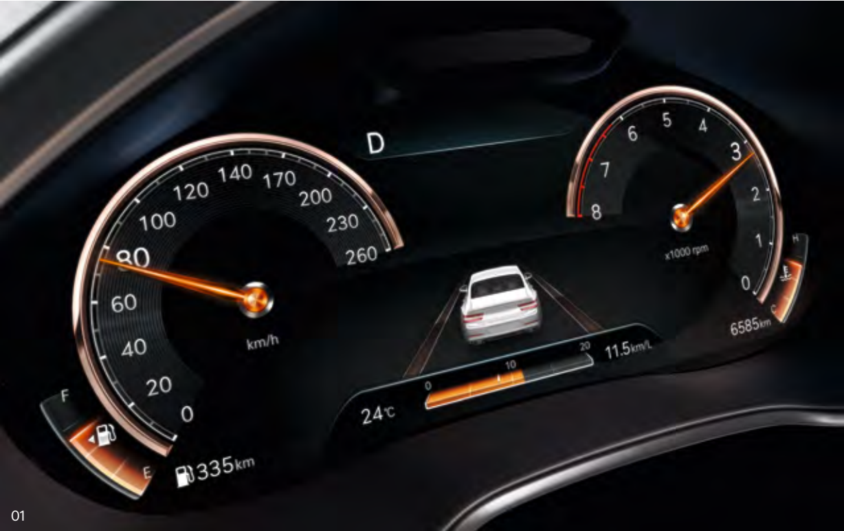
01. Трёхмерная цифровая приборная панель _ В зависимости от выбранного режима вождения широкоформатный 12,3-дюймовый 3D-дисплей высокого разрешения меняет стиль представления информации. Встроенная камера следит за направлением взгляда водителя и подстраивает изображение, сохраняя трёхмерную картинку под любым углом зрения.
