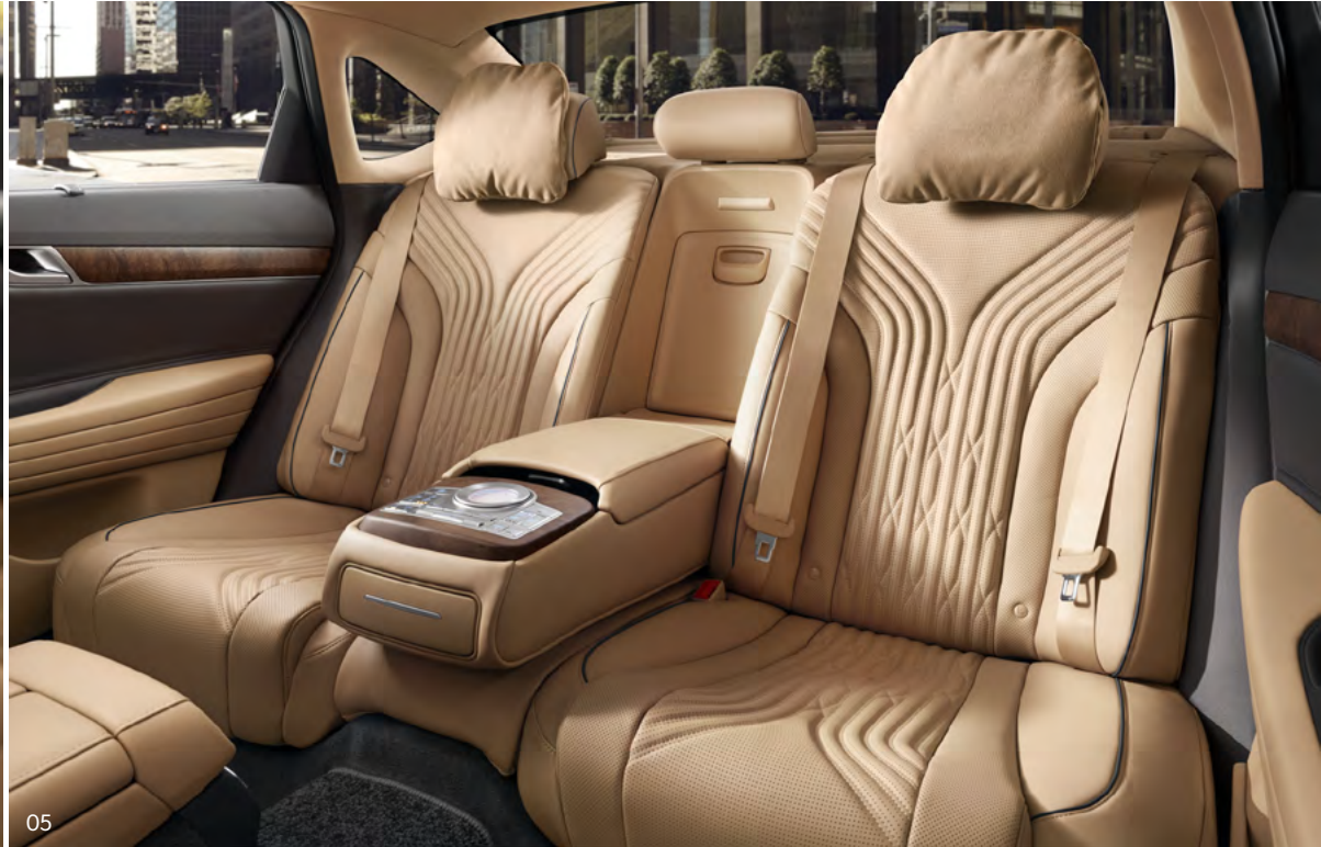
05. Задние сиденья с электроприводом, подогревом и вентиляцией _ Положение задних кресел регулируется в широком диапазоне для создания максимального комфорта для пассажиров. Оба сиденья оборудованы системами подогрева и вентиляции. Интенсивность циркуляции воздуха зависит от скорости движения автомобиля. Управление подогревом и вентиляцией осуществляется как пассажирами задних сидений, так и водителем через пульт, расположенный на центральной панели.
